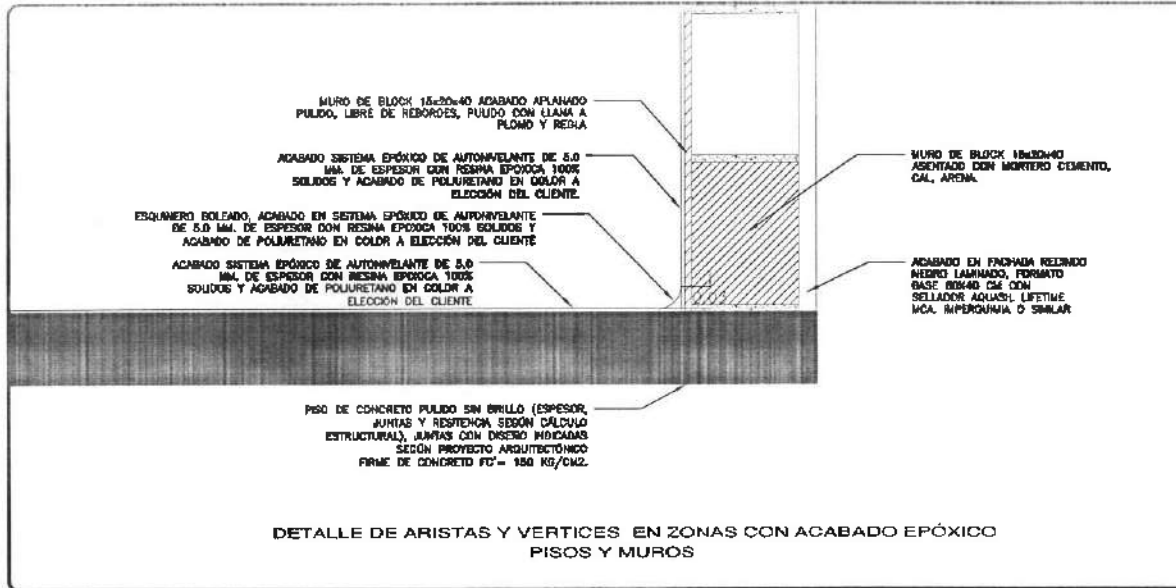
DETALLE BOLEADO ESCALA 1:5
