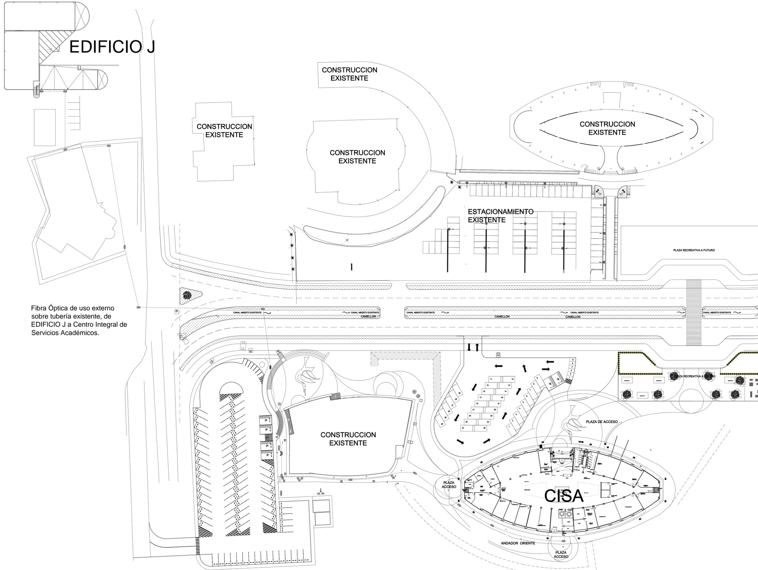
Fibra Óptica de uso externo sobre tubería existente, de EDIFICIO J a Centro Integral de Servicios Académicos.
