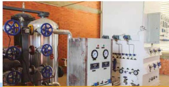
■ Equipamiento para la generación de nitrógeno líquido
