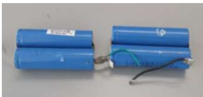
Figura 5. Batería ion-Li desmantelada
