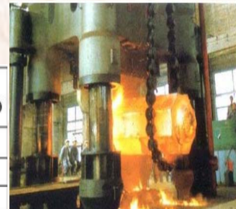
Prensa hidráulica de 15.000 Tm para la forja libre de ejes de barco
