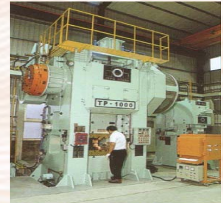
Prensa mecánica de 1000 Tm para forja en caliente
