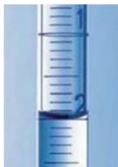
Figura 3. Ajuste de menisco a 2 ml de agua en probeta graduada
