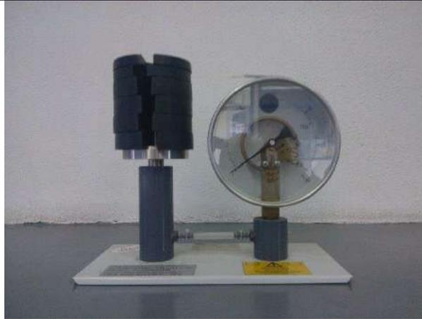
**Figura 2** Calibrador de manómetros tipo Bourdon
