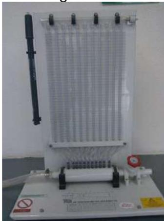
Figura 1 Venturímetro de laboratorio.
