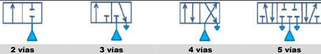
Figura 7. Entrada y escape de aire.
