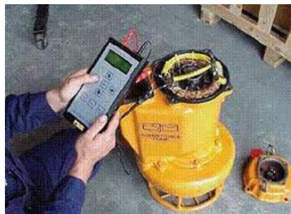
Figura 1 Falla de aislamiento en devanado del estator
